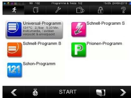
Mit dem Start des Programms schließt die Tür druckdicht. Der Autoklav prüft die Menge des Speisewassers und dessen Leitwert.
